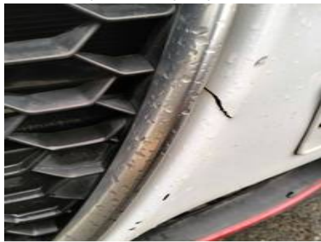
Bouclier avant (Défaut aspect)
